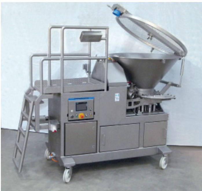
Fülltrichter mit Rührwerk und manuell zu öffnendem Deckel
