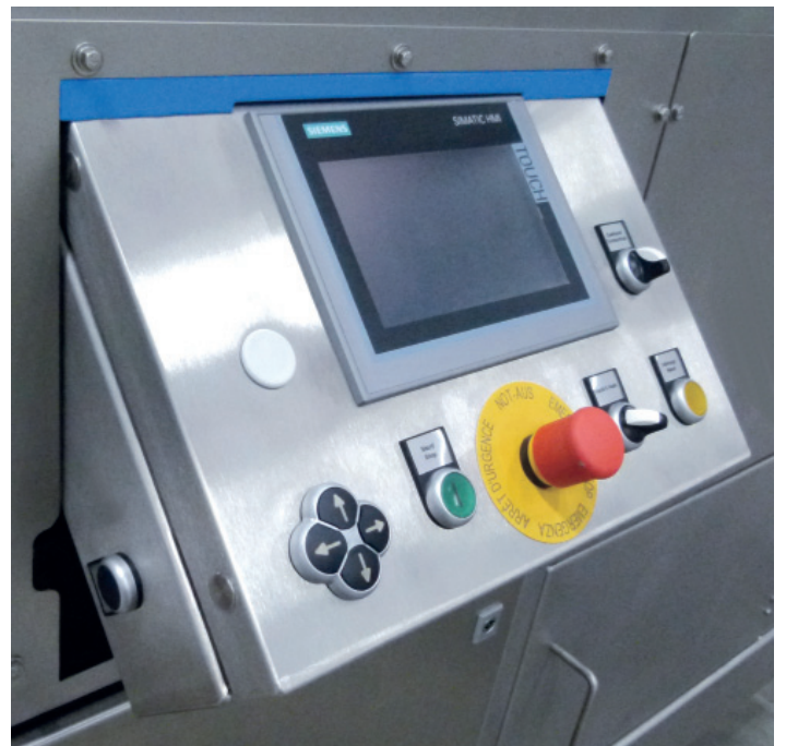
Klappbares übersichtliches Panel zur einfachen Bedienung
